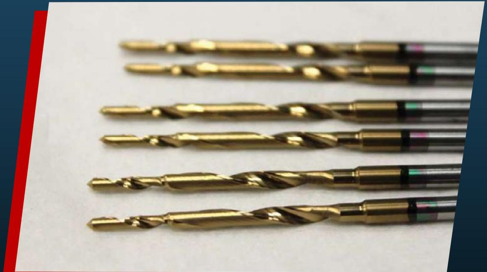
Spezialbohrer mit leitfähigen und isolierenden Hartschichten aus Titannitrid (TiN) und Siliziumnitrid ( $\text{Si}_3\text{N}_4$ ).
